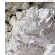
spegnimento del ciottolo slaking of quick lime
